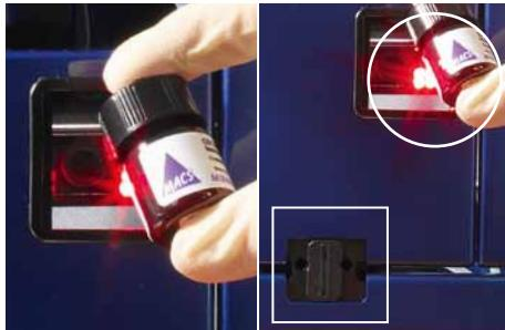
Abbildung 1.3: Position von Lasern. Im Bereich des Rechtecks befinden sich verdeckt montierte Laser zur Erkennung von Gestellen. Der (sichtbare) 2D-Barcodeleser ist hier mit einem Kreis gekennzeichnet.
