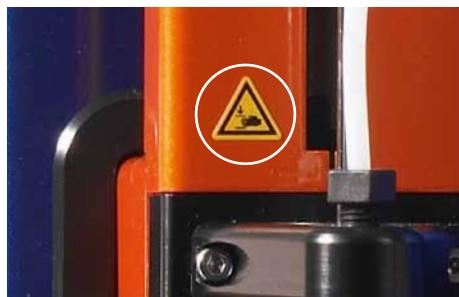
Figura 1.2: El círculo abierto muestra la señal de advertencia para el peligro de aplastamiento o corte.
