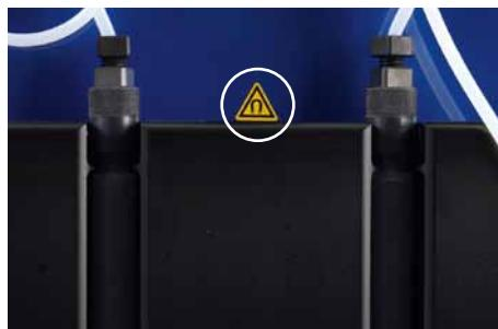
Figura 1.1: Segnale di avvertenza per forte magnete permanente.
