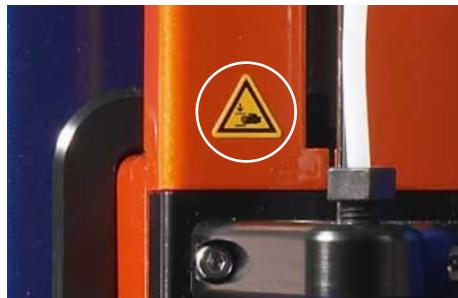
Abbildung 1.2: Der Kreis zeigt das Warnsymbol für Quetsch- und Schergefahr.
