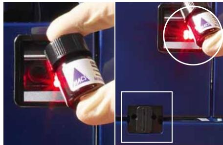
Figura 1.3: Posición de los láseres. El láser de detección del rack es invisible y se localiza dentro del área rectangular. El lector de códigos de barra (visible) está localizado dentro del círculo abierto.
