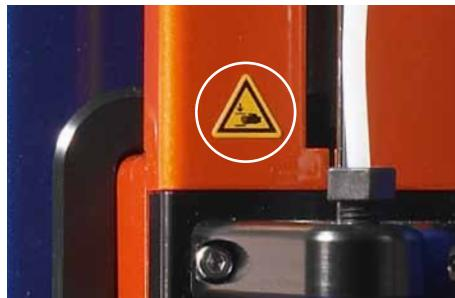
Figura 1.2: Il cerchio indica il segnale di avvertenza per il pericolo di schiacciamento e di taglio.
