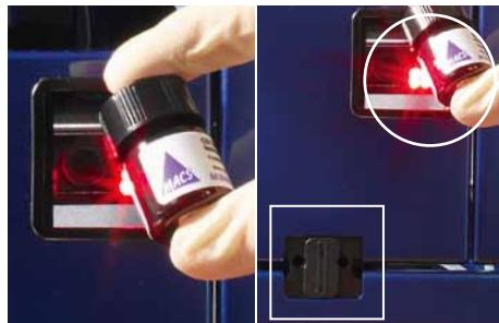
Figura 1.3: Posizione dei laser. Laser invisibili per il rilevamento dei portacampioni/portareagenti sono collocati nell'area indicata dal rettangolo. Il lettore per codice 2D (visibile) è collocato all'interno del cerchio.
