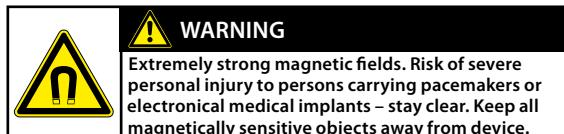
**WARNUNG!** Der autoMACS Pro Separator enthält einen extrem starken Magneten. Halten Sie mit magnetischen Datenträgern (Kreditkarten, Magnetbänder, Speichermedien und dergleichen) und elektronischen Geräten (wie Hörgeräte, Herzschrittmacher,
