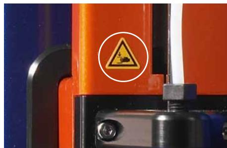
Figure 1.2: Le symbole d'avertissement entouré d'un cercle blanc indique un risque d'écrasement et de cisaillement.
