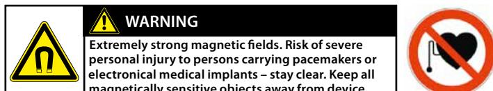
**AVERTISSEMENT!** Le séparateur autoMACS Pro est équipé d'un aimant extrêmement puissant. Veillez à laisser un espace d'au moins 20 cm entre le cache de l'aimant et les supports 'information magnétiques (cartes de crédit, bandes magnétiques et supports de données) ainsi que l'équipement électronique (appareils auditifs, pacemakers, dispositifs de mesure et de contrôle, ordinateurs et
