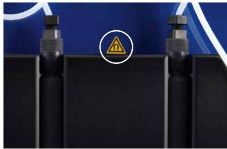
Abbildung 1.1: Warnsymbol für starken Dauermagnet.
